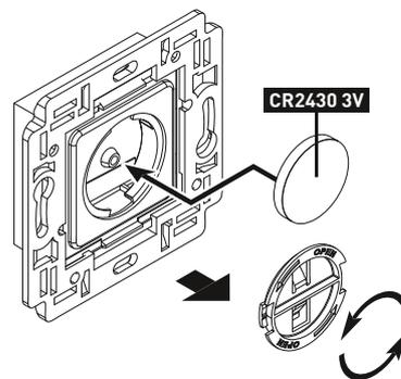
**nl** Batterij is reeds geplaatst bij levering. Levensduur batterij bij normaal gebruik: 3 à 5 jaar
