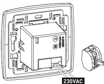
**nl** Verbind de netspanningskabels met de reeds aanwezige voedingskabels van de component d.m.v. lasklemmen (niet meegeleverd)
