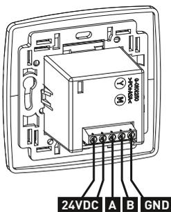
**nl** Sluit de kabel van 5 x 0,8 mm<sup>2</sup> vaste kern aan d.m.v. de schroefconnectoren
